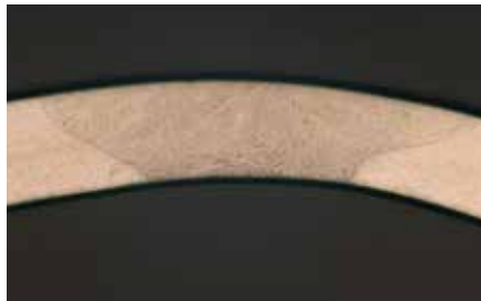
Herkömmliche breite WIG-Schweißnaht
