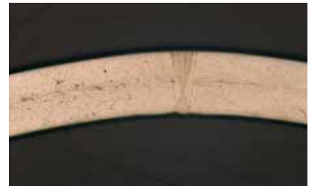
Schmale Viega Laserschweißnaht
