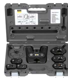
Pressringset PT2 für metallene Pressverbindersysteme.
