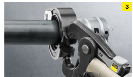
3 Der Verbinder wird mit einer Viega Pressmaschine sekundenschnell verpresst und kraftschlüssig mit dem Rohr verbunden.
