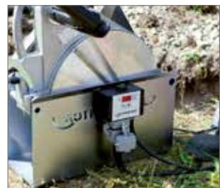
Profesionalna hidravlika z velikim enostavno berljivim merilnikom tlaka, omejevalnikom tlaka in razbremenilnim ventilom
