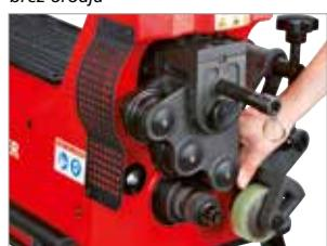
Komplet (Št. 1500001351) vsebuje: ROGROOVER stroj 1 - 12", set kolesc za ožlebitev 2 - 6", set kolesc za ožlebitev 1-1/2", set kolesc za ožlebitev 8 - 12", cevno podporno stojalo, orodje za instalacijo, merilni trak premera- CD za instalacijo in uporabo.
